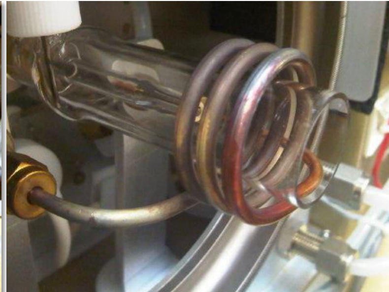
48 órával később Argon: 18 L/min, teljesítmény: 1600 W
